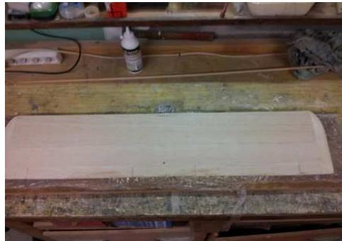
Pose du dessus du fuselage (Planche 20/10 collé avec les fils du bois collés en travers)
