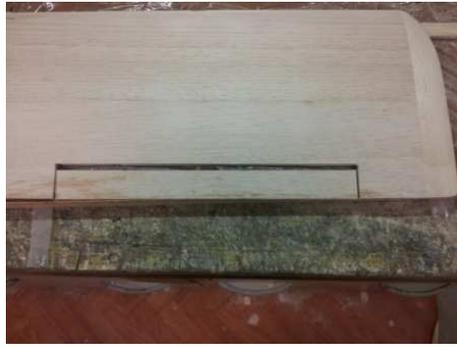
Tailler dans une planche de 30/10 les baguettes qui viendront fermer l'aile et les ailerons.
