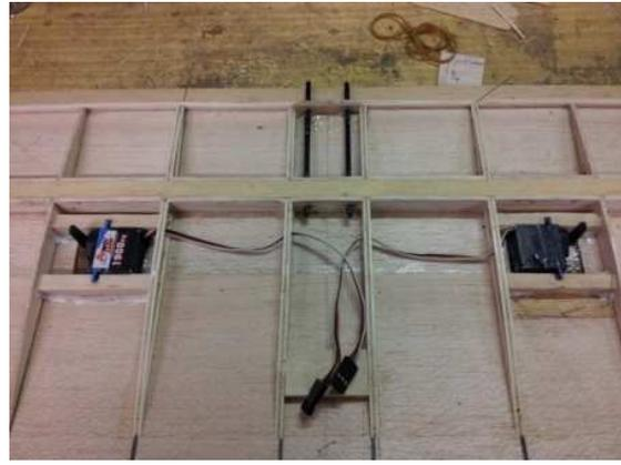
Il faudra penser, lors de la mise en place du coffrage superieur a passer un fil pour recuperer les fils de servos.
