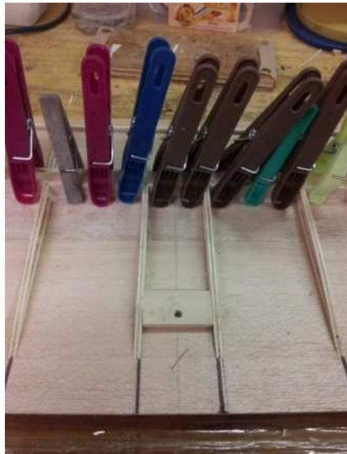
Pendant le séchage, découpe du stabilisateur. Celui-ci sera constitué de deux planches de 20/10 qui seront collées l'une contre l'autre, avec au milieu, un tissu de 50 Gr/Dm<sup>2</sup> de fibre de verre. Cela nous permettra d'avoir des bords de fuite aussi fins que des lames de rasoir, et très solide !
