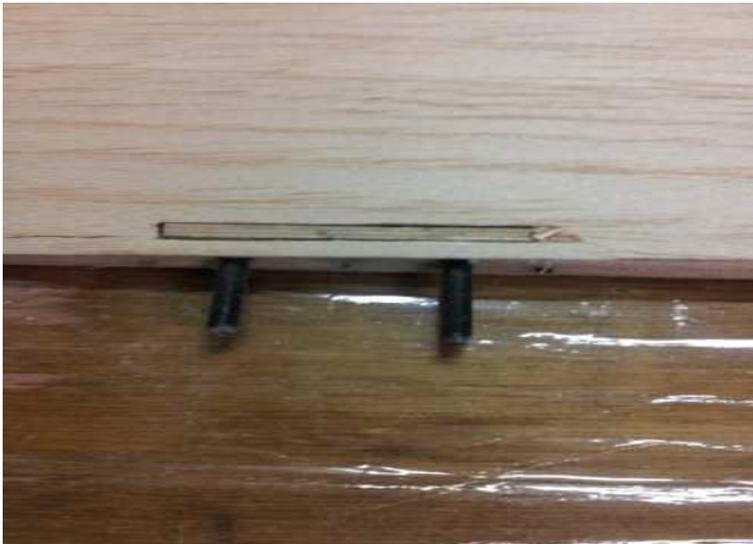
Préparer deux fils de couture avec un petit morceau de balsa accroché, qui sont passés par les trous des quatre nervures centrales et qui sortiront dans le trou qui aura été fait au centre de l'aile. Comme un kit RTF (Ready To Fly) , ces fils serviront à passer les câbles de servos après le coffrage.
