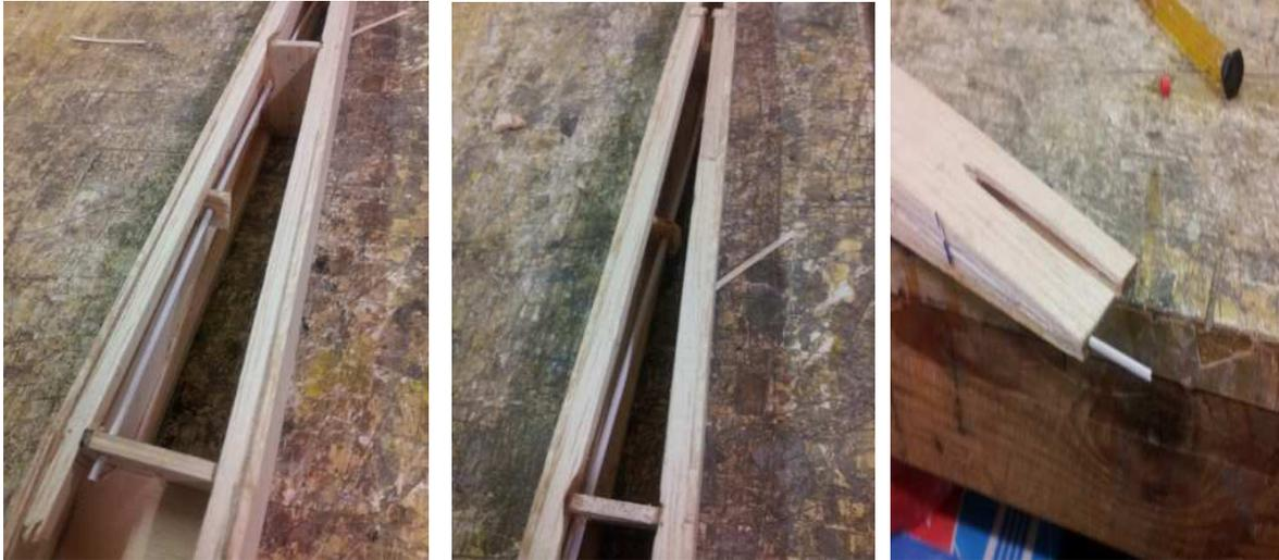
Collage des deux tiges de carbone qui servent a tenir l'aile au fuselage sur sa partie avant.
