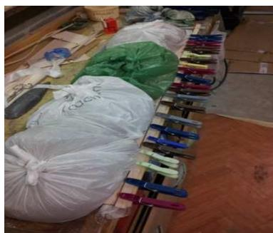
On pince le bord de fuite avec deux baguettes aussi protégées avec du scotch large (pour qu'elles ne restent pas collées) et une multitude de pinces et on touche plus 24 heures minimum.
