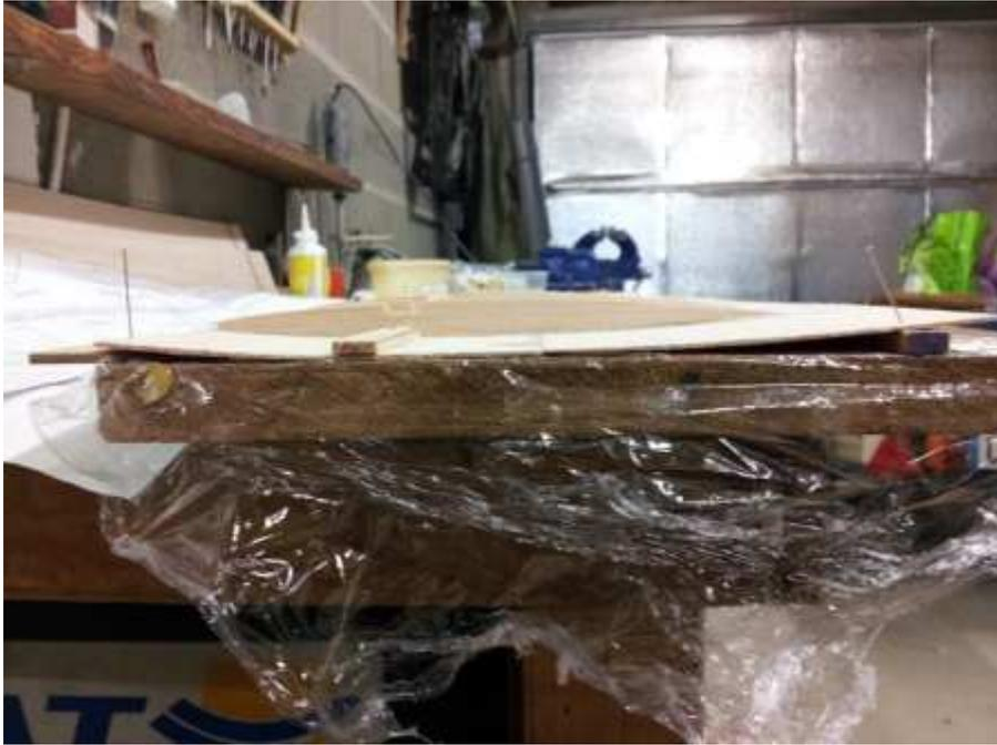
Collage du longeron inférieur pin 10x3 et des 2 nervures centrales avec la plaque de fixation
