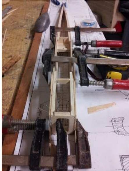
Lorsque tout cela est sec, on peut passer a l'arrière du fuselage en collant le couple C4 ainsi que les petits guides qui maintiendront la dérive. On fera très attention a l'alignement du fuselage complet.
