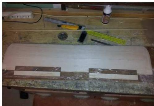
Redécouper sur l'aile et les ailerons, une épaisseur de 3 mm.
