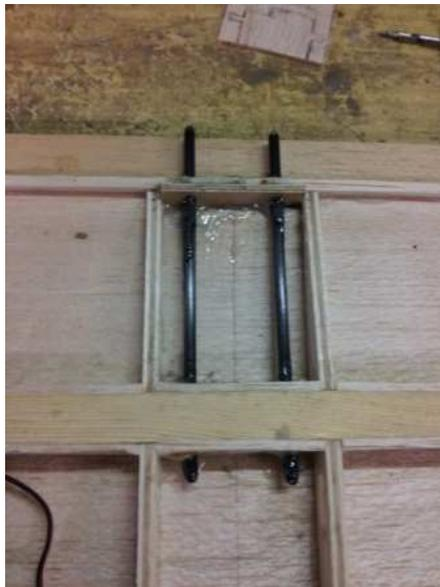
Préparation des fixation de servos d'aileron.
