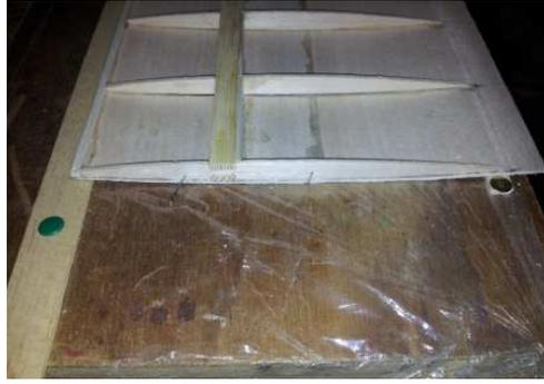
une colle époxy min 30mn ou colle blanche et de la résine époxy normal (24h) sont nécessaires on commence par préparer 5gr de résine pour imprégner le ruban de verre sur le bord de fuite
