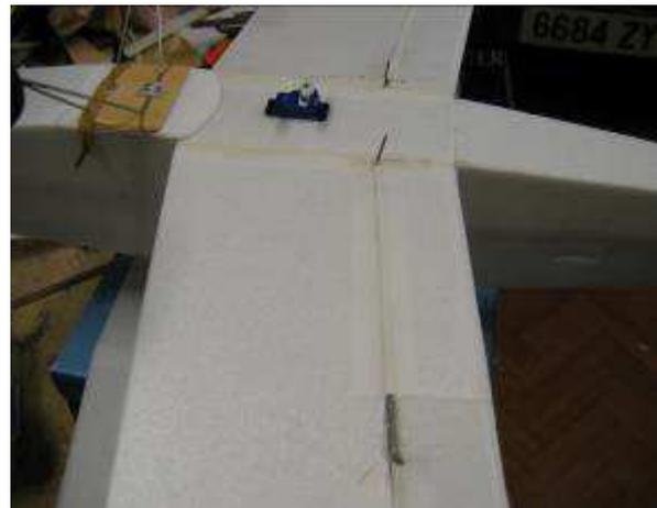
Relier les ailerons des ailes avec une tige de carbone et de la gaine thermo rétractable de la même façon de que Troll. Ces tiges de commandes se posent juste derrière les haubans des ailes.
