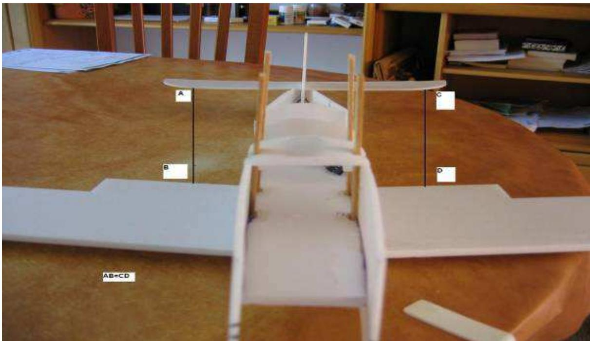
Mise en place des servos de profondeur et de direction et de l'emplacement de la batterie. Les servos seront collés avec du double face sur l'âme centrale, avec une goutte de cyano sous les pattes de fixation et contre le flanc dépron.
