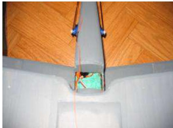
Le contrôleur est logé a coté de la batterie à l'avant sous la trappe amovible.
