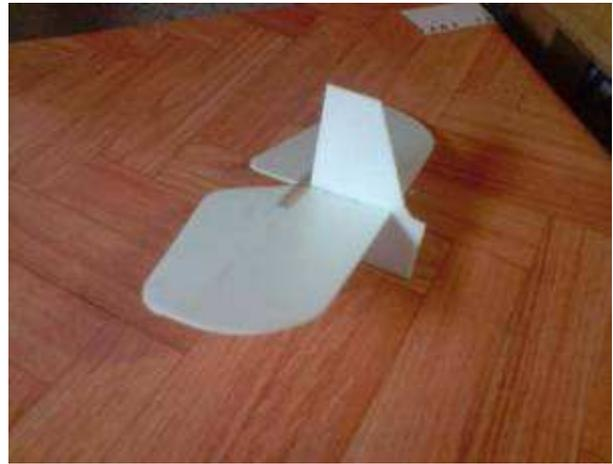
Maintenant, coller l'ensemble des empennages sur le fuselage, en insérant le bas de la dérive dans la fente de l'âme du fuselage. Bien vérifier les angles du stabilisateur.
