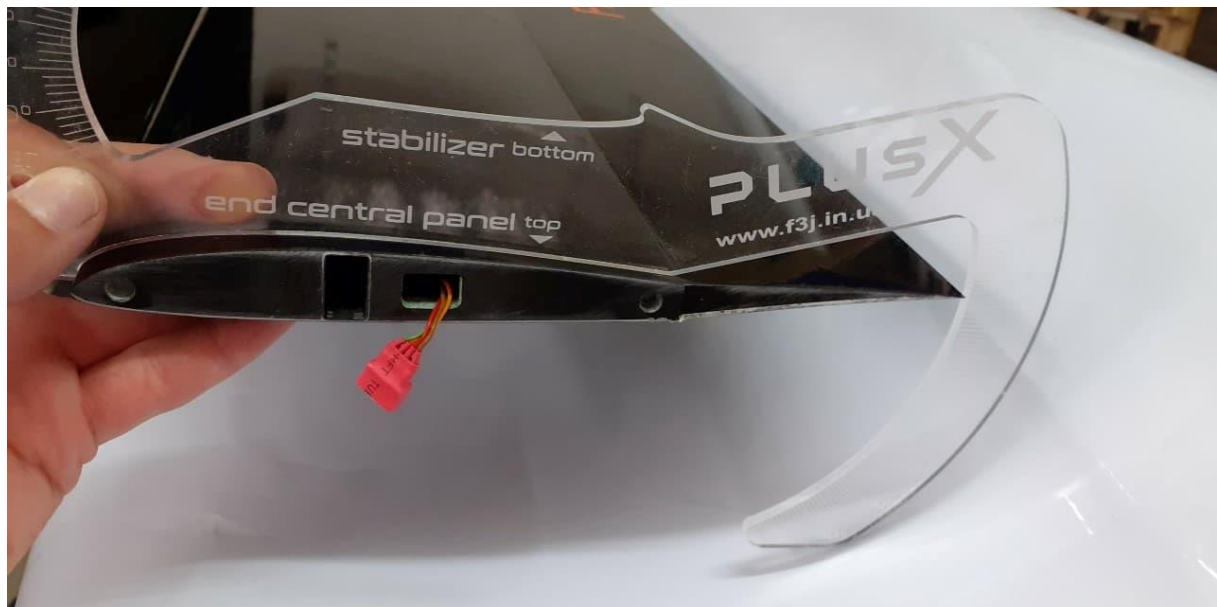
Outil permettant de mesurer précisément le débattement des gouvernes pour symétriser les réglages par exemple.
